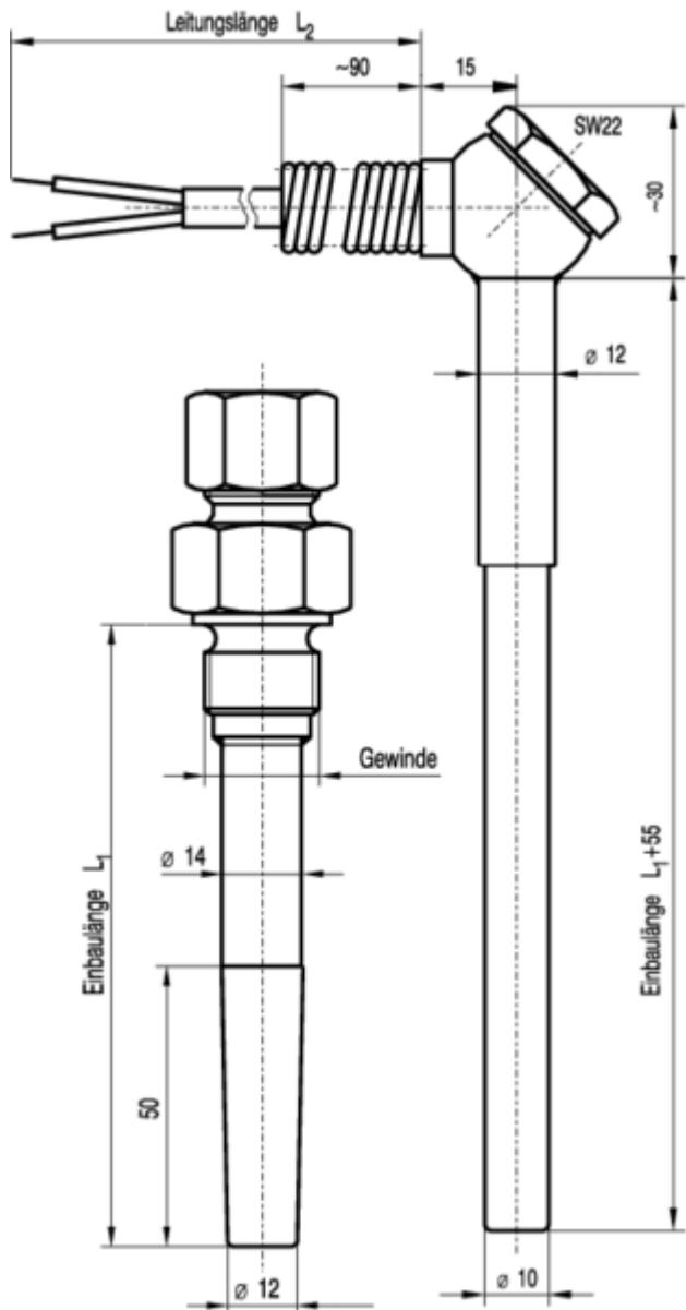
mit fest angeschlossener Ausgleichsleitung und Zusatzschutzrohr mit Klemmverschraubung mit Metallklemmring
