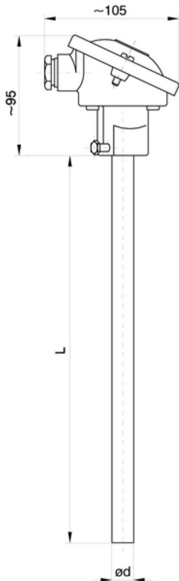
Thermoelement mit metallischem Aussen- und keramischem Innenschutzrohr,
