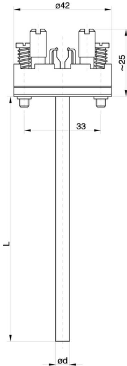
Messeinsatz zum Einbau in Schutzarmaturen
