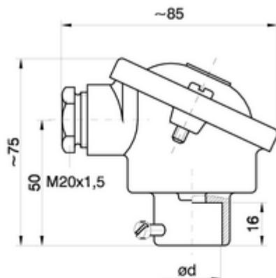
Anschlusskopf für Widerstandsthermometer und Thermoelemente
