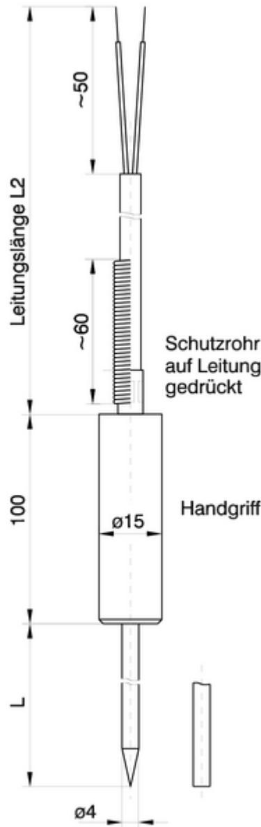
Widerstandsthermometer mit Anschlusskabel zum Einstechen
